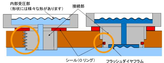
標準品は接続部の内部の穴を通じて流体が入ってきます。そのため粘性の高い流体やスラリー、 粉体の混入した流体では、内部の穴の中で詰まりが生じ、正確な圧力計測ができない場合があり ます。その場合はフラッシュダイヤフラム型をご採用いただくことを推奨しております。
